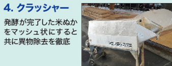
4. クラッシャー 発酵が完了した米ぬかをマッシュ状にすると共に異物除去を徹底
